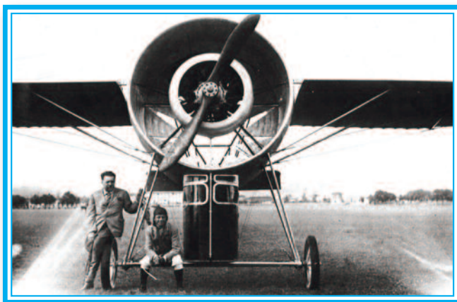
Mattioni ed il bravissimo pilota Magrini con la Botte Volante nel 1923. Si notano i flabelli per strozzare il flusso d'aria in uscita dal tubo
